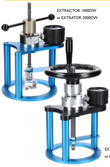
La gamme EXTRACTOR est idéale pour tester la qualité des fixations et des points d'ancrage. Elle vous permettra de valider facilement la force d'arrachement en fonction des différents matériaux et fixations que vous avez à contrôler.
